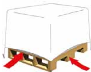
Placer pallen på et tørt og plant underlag. Afdæk og etabler ventilation omkring pladerne. Dette er med til at forhindre kalkudfældninger.
